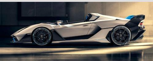
Motorisée par le V12 atmosphérique (6 498 cm<sup>3</sup>) qui développe donc 770 ch (à 8 500 tr/min) et un couple de 720 Nm (à 6 750 tr/min), la SC20 dispose d'une transmission intégrale et d'une boîte de vitesses ISR (Independent Shifting Rod) à sept rapports.
