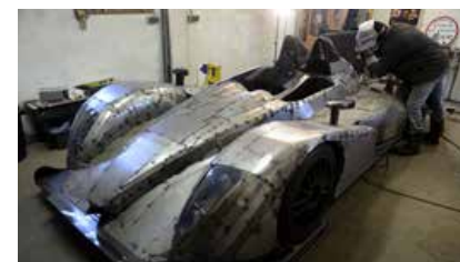
Fernando Costa en action dans son atelier de Gignac dans le Lot. Première couche composée de plaques d'acier rivetées sur la coque. Fernando Costa in action in his workshop in Gignac, Lot. First layer made of steel plates riveted to the hull. ©DPPI
