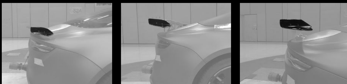
Illustrations des différentes positions de l'aileron arrière testées en soufflerie.
